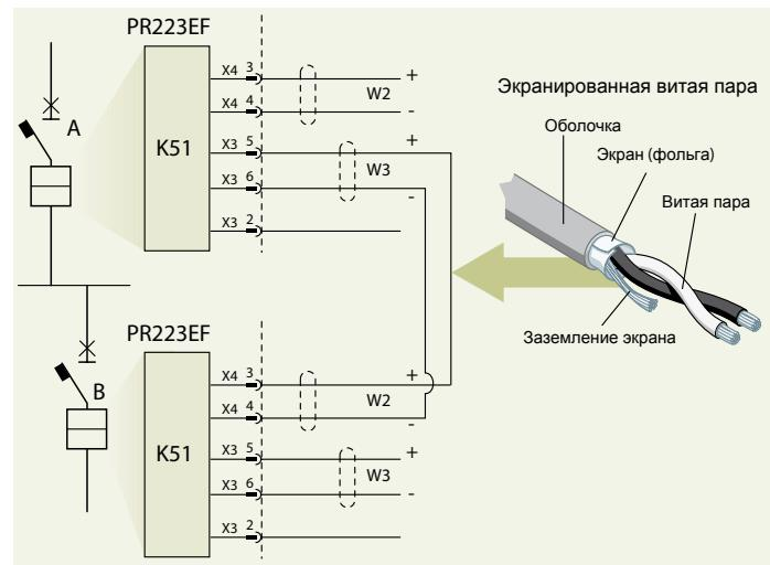
Заземление экрана кабеля должно производиться на стороне клеммы W3.
