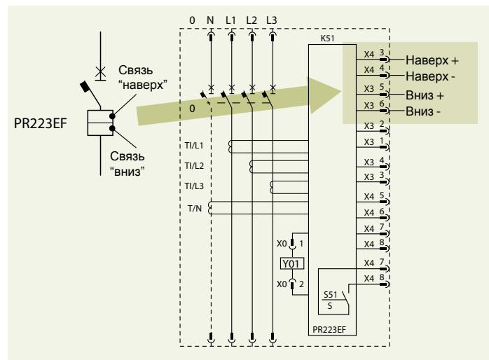
Рисунок ниже показывает последовательное соединение выключателей А и В; селективность гарантируется только при правильном соединении расцепителей PR223EF по соответствующим клеммам связи наверх/вниз (пример полной схемы подключения смотрите на странице 9).
